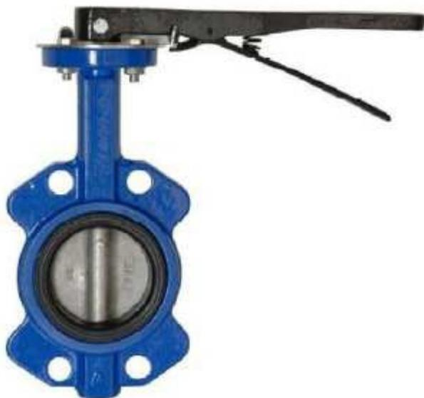
Válvula Borboleta manual, corpo em FoFo, disco e eixo em Al 304(CF8), vedação EPDM, acionamento manual por alavanca com caixa de redução ou base ISO 5211.
